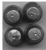
U ispitivanom materijalu nastaje otisak u obliku kalote promjera baze  $d$  i dubine  $h$ .
