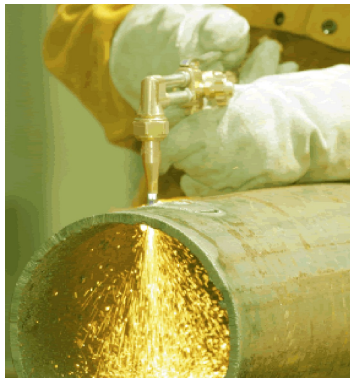
Rezanje plamenom – plamenik ima dodatni dovod čistog kisika koji izlazi u jakom mlazu i uklanja rastaljeni metal (metal izgara u velikoj količini kisika).
