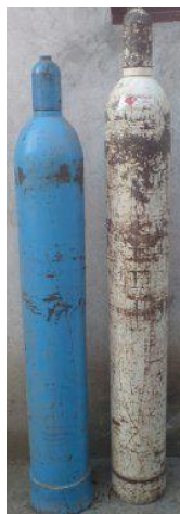
Boce za kisik (plava) i acetilen (bijela) za plinsko zavarivanje
