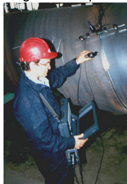
Ispitivanje zavarenog spoja ultrazvukom
