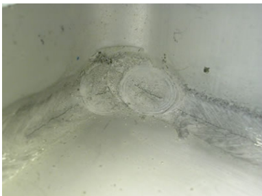
Test zavarljivosti na aluminiju
