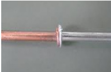
Hladno zavareni spoj
